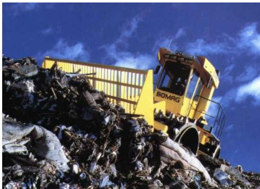
Συμπιεστής (Compactor) Πηγή: BOMAG, Αφοι Σιβρή
