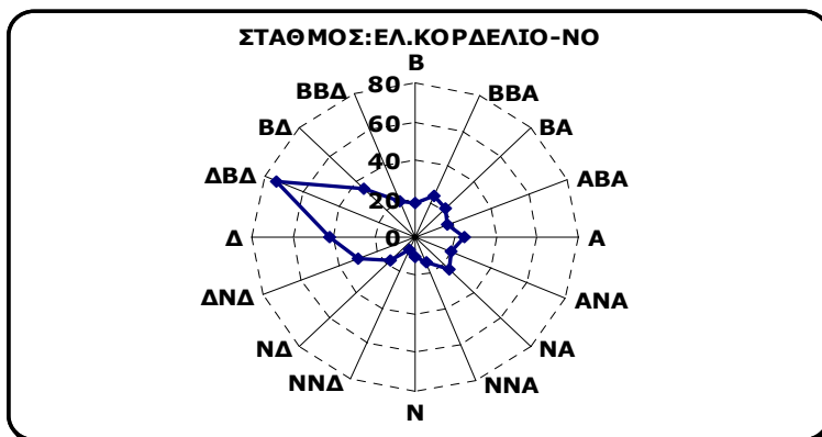
Σχήμα 8.12. Μέσες τιμές μονοξειδίου του αζώτου (NO) σε µg/m 3 στον σταθμό του Ελευθερίου-Κορδελιού για το έτος 2003 για κάθε διεύθυνση ανέμου
